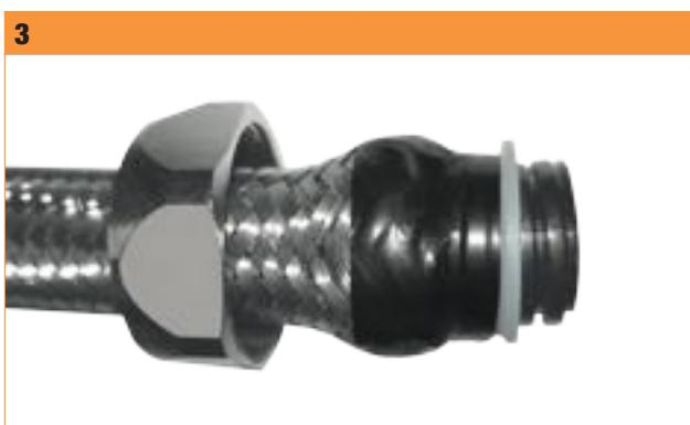
Riportare in avanti la treccia fino a sormontare la boccolla di nylon nella sua sede senza sopravanzarla e avvolgerla con nastro adesivo
