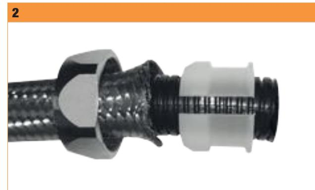
Spingere indietro la treccia e montare sul tubo in Nylon la boccolla a filo tubo come mostrato in figura
